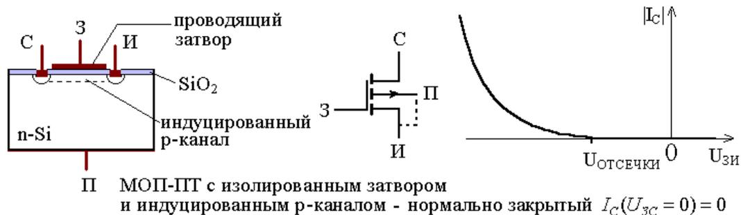
Достоинства - диэлектрическая изоляция затвора с малыми токами утечки ( $I_3 \sim 1pA$ ), высокие крутизны ( $S \sim 5 \div 40mA/V$  при  $I_C \sim 10mA$ ), высокие рабочие частоты (до  $f \sim 2GHz$ )
